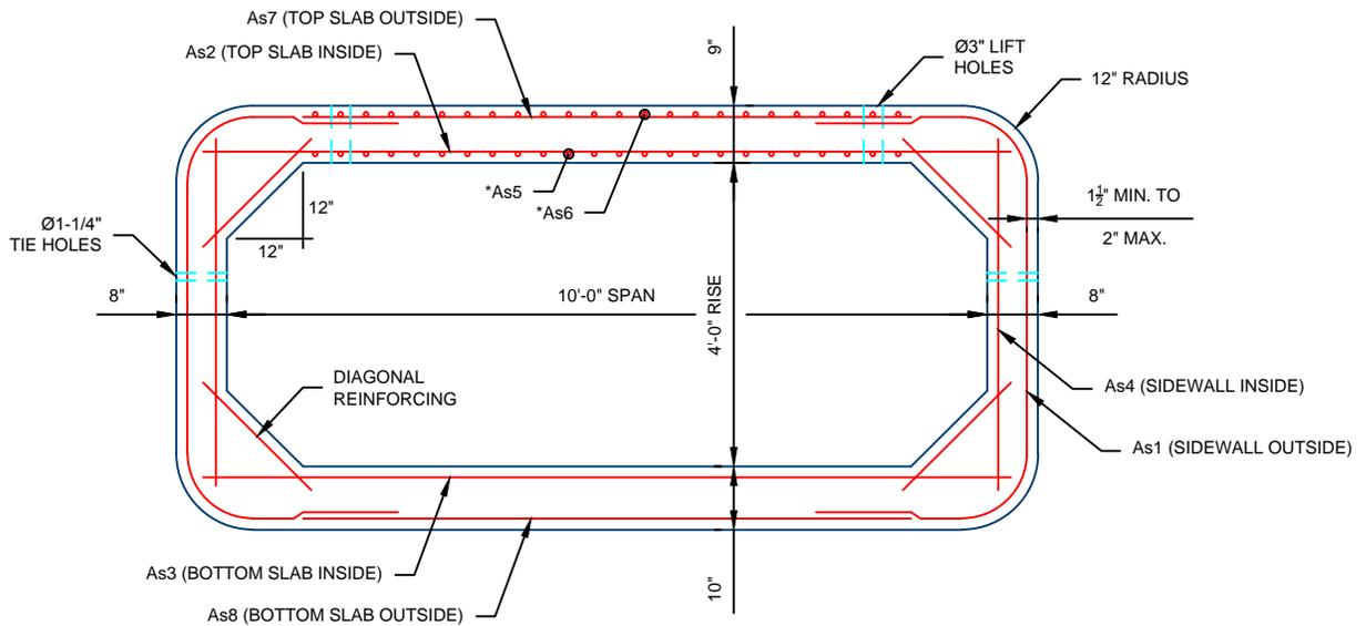
\*As5 & As6 REPRESENT DISTRIBUTION STEEL IN THE TOP SLAB WHEN REQUIRED.
