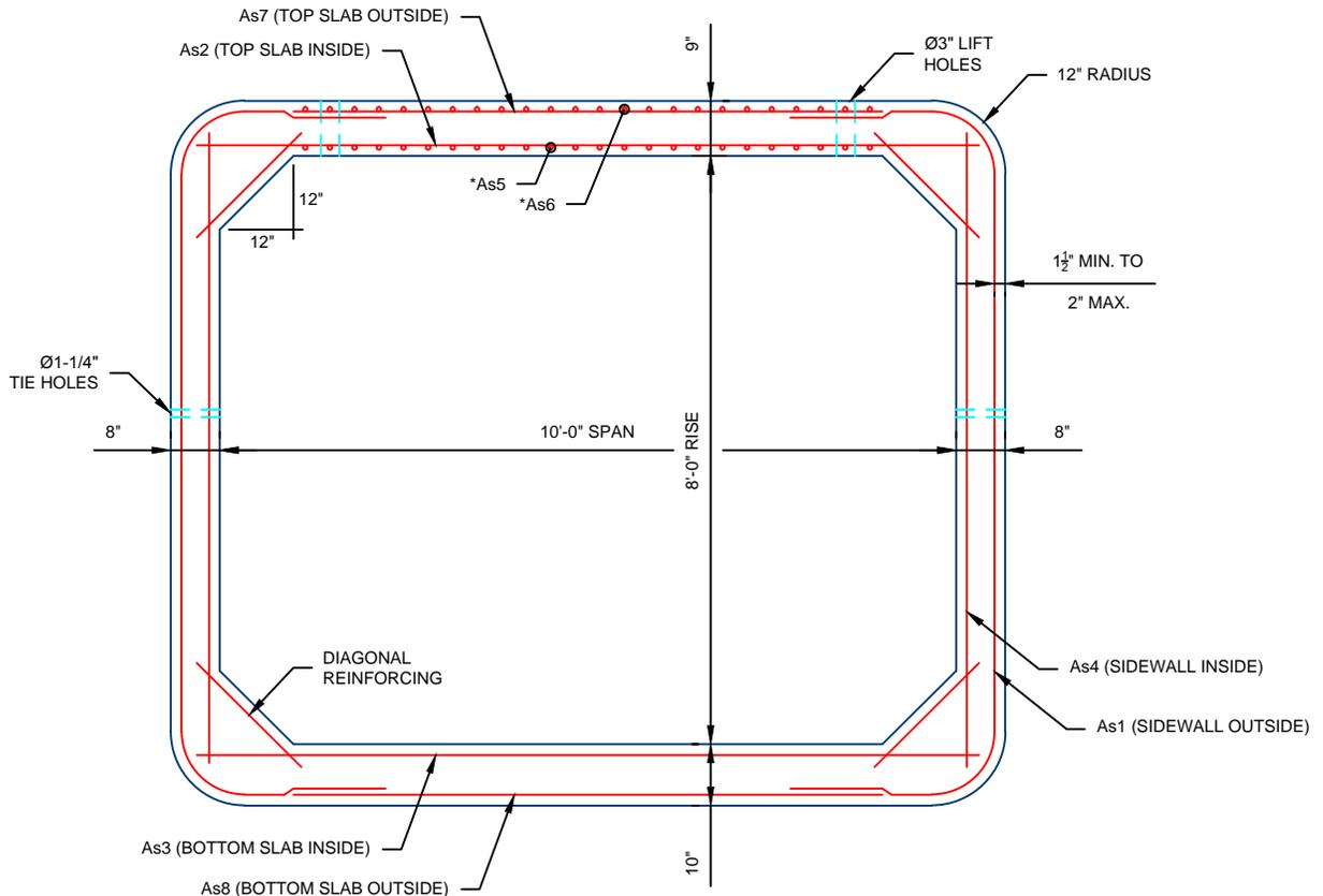
\*As5 & As6 REPRESENT DISTRIBUTION STEEL IN THE TOP SLAB WHEN REQUIRED.
